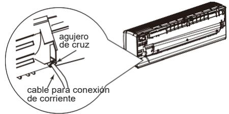
3. Remueva el broche de alambre; conecte el cable de corriente a la terminal de cableado de acuerdo a los colores; apriete el tornillo y después fije el cable de conexión de corriente con el broche de alambre.
