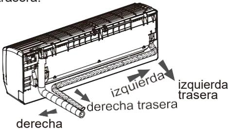
2. Cuando seleccione la salida del tubo de izquierda o derecha, favor de cortar el agujero correspondiente en la parte inferior de la carcasa.
