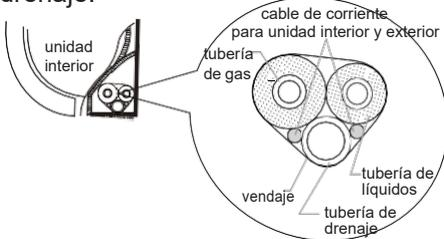
2. Conserve sin vendar cierta longitud de manguera de drenaje y cable de corriente, cuando aplique el vendaje. Al aplicar el vendaje a cierto grado, separe el cable de corriente y después separe la manguera de drenaje de la unidad interior.
