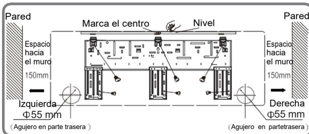
2. Abra el agujero para la tubería con un diámetro de  $\Phi 55$  en la posición seleccionada para la salida del tubo. A fin de que drene correctamente, incline ligeramente hacia abajo el agujero en la pared, que va hacia afuera, entre 5-10°.
