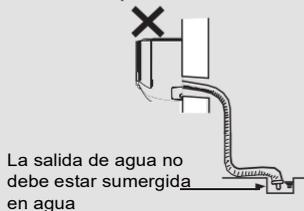
• Incline la manguera de drenaje ligeramente hacia abajo. La manguera de drenaje no puede estar curvada, elevada ni ondulada, etc.
