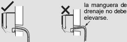
• La salida de agua no debe sumergirse en agua, con el fin de drenar sin problemas.
