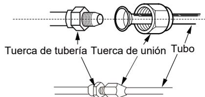
3. Ajuste de la siguiente manera: Coloque la llave de horquilla en la tuerca de la tubería y la llave de torsión en la tuerca de unión. Ajuste la tuerca de unión con la llave de torsión.
