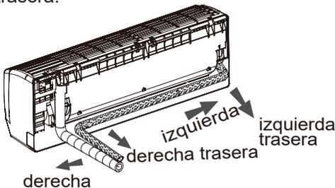
2. Cuando seleccione la salida del tubo de izquierda o derecha, favor de cortar el agujero correspondiente en la parte inferior de la carcasa.
