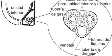
2. Conserve sin vendar cierta longitud de manguera de drenaje y cable de corriente, cuando aplique el vendaje. Al aplicar el vendaje a cierto grado, separe el cable de corriente y después separe la manguera de drenaje de la unidad interior.
