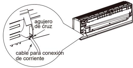
3. Remueva el broche de alambre; conecte el cable de corriente a la terminal de cableado de acuerdo a los colores; apriete el tornillo y después fije el cable de conexión de corriente con el broche de alambre.
