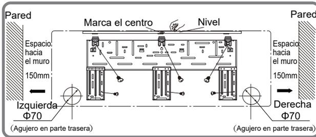
2. Abra el agujero para la tubería con un diámetro de  $\Phi 70$  en la posición seleccionada para la salida del tubo. A fin de que drene correctamente, incline ligeramente hacia abajo el agujero en la pared, que va hacia afuera, entre 5-10°.
