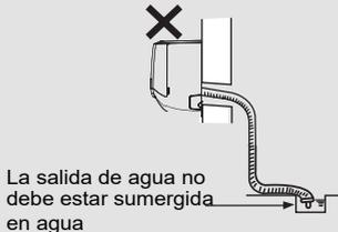
• Incline la manguera de drenaje ligeramente hacia abajo. La manguera de drenaje no puede estar curvada, elevada ni ondulada, etc.
